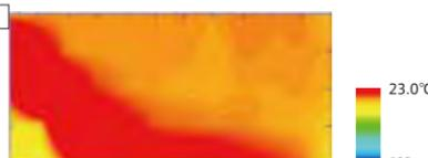
\*AS-X40F2にて。当社環境試験室(14畳)。外気温2℃、室内温度10度、設定温度25度。設定風量強風時、左右風向正面、上下風向暖房標準、サイドファン運転時。
